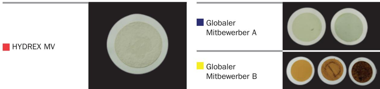
Filter wurden gewechselt, wenn Filterverstopfung den Flüssigkeitsfluss behinderte. HYDREX MV Filter benötigten während der Testdauer nur einen Filter.
